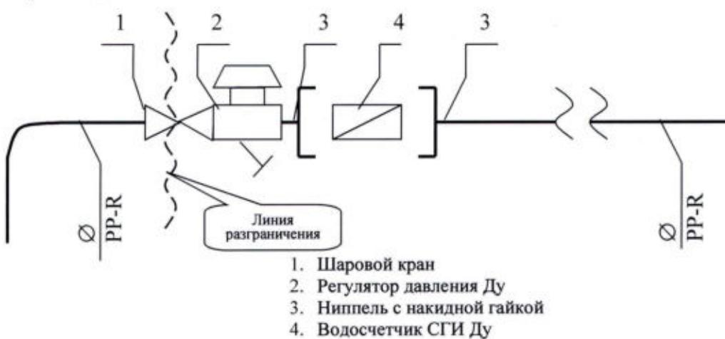
Исполнитель несет ответственность за надлежащее состояние и работоспособность систем горячего и холодного водоснабжения согласно вышеуказанной схеме до волнистой линии слева (включая шаровой кран).
